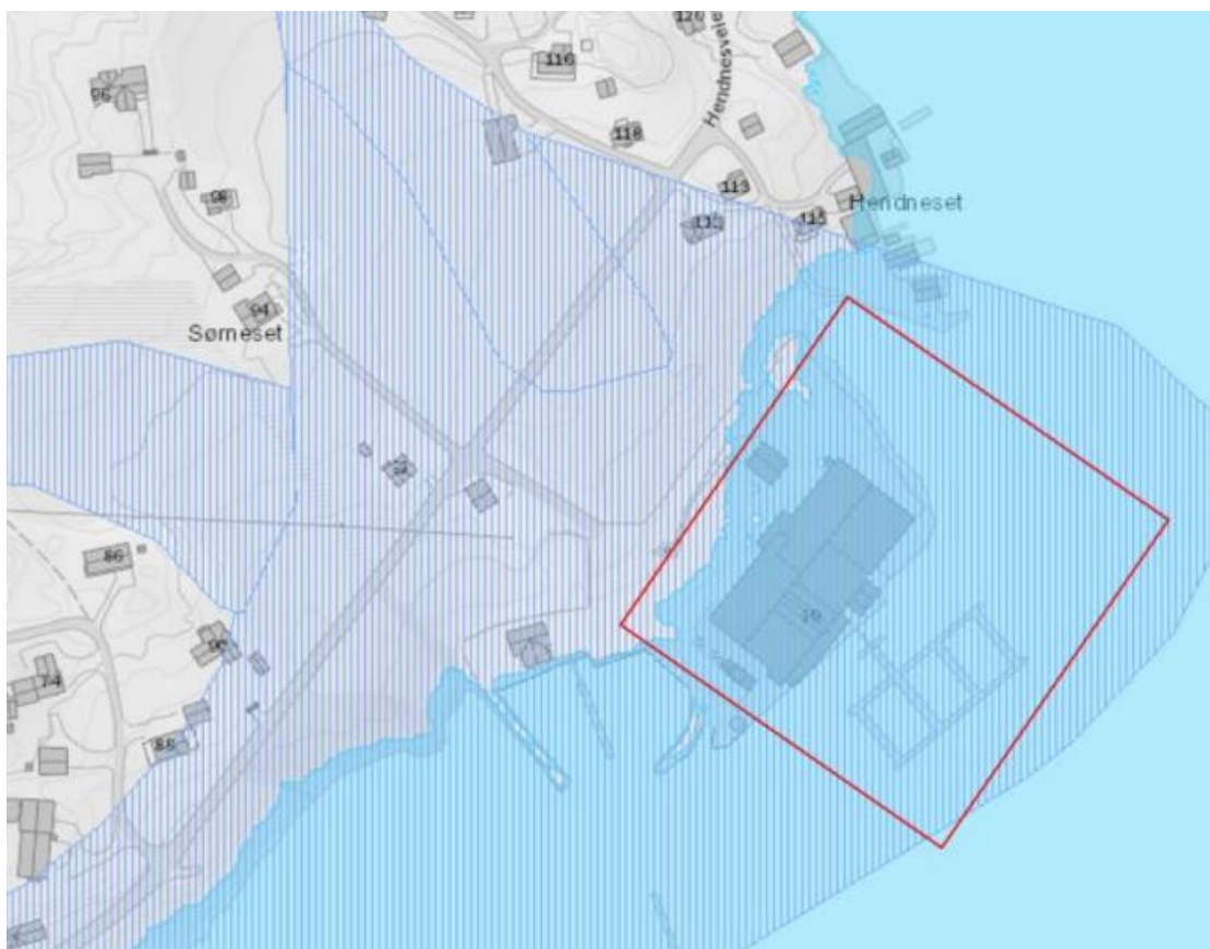
Illustrasjon. Registrerte naturfarer hentet fra geoteknisk rapport som viser stormflo 200-års gjentaksinervall (blå farge) og utstrekning marin leire (vertikal skravur). (Vedlegg 4)
