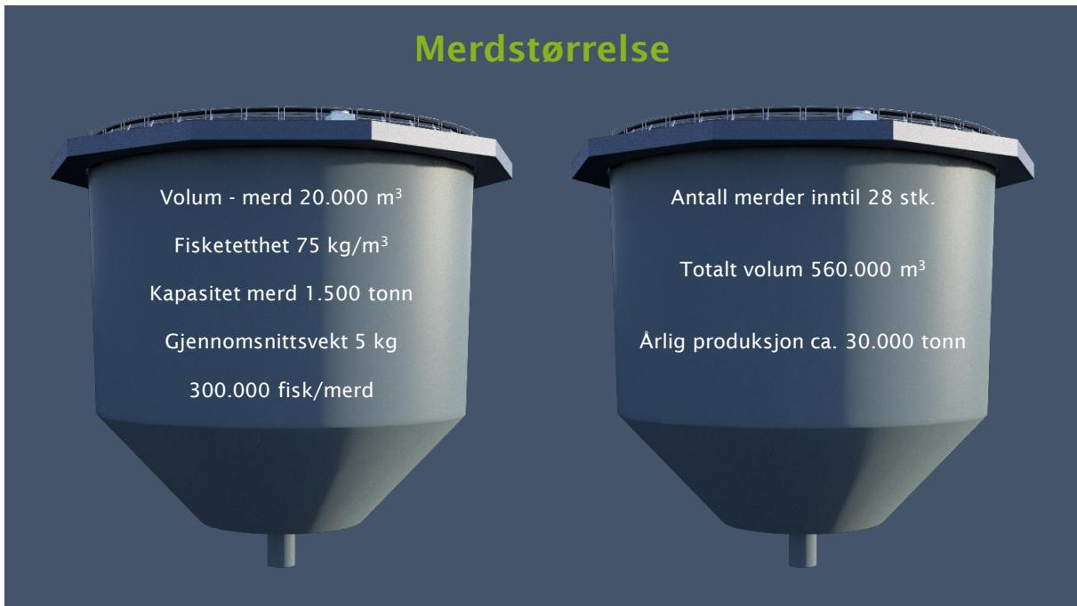
**Figur 4.** Skisse av lukket merd samt angitte tekniske spesifikasjoner inkludert fisketethet og forventet mengde fisk i hver enkelt merd og samlet i anlegget (fra Averøy Seafood AS).
