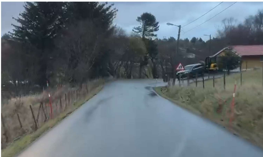
Figur 5 Siktforhold ved krapp kurve etter høybrekk
