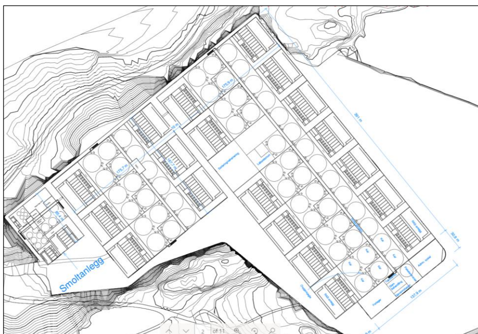
Figur 10: Mulig utforming av oppdrettsanlegget. (AIP/NORCAD)
