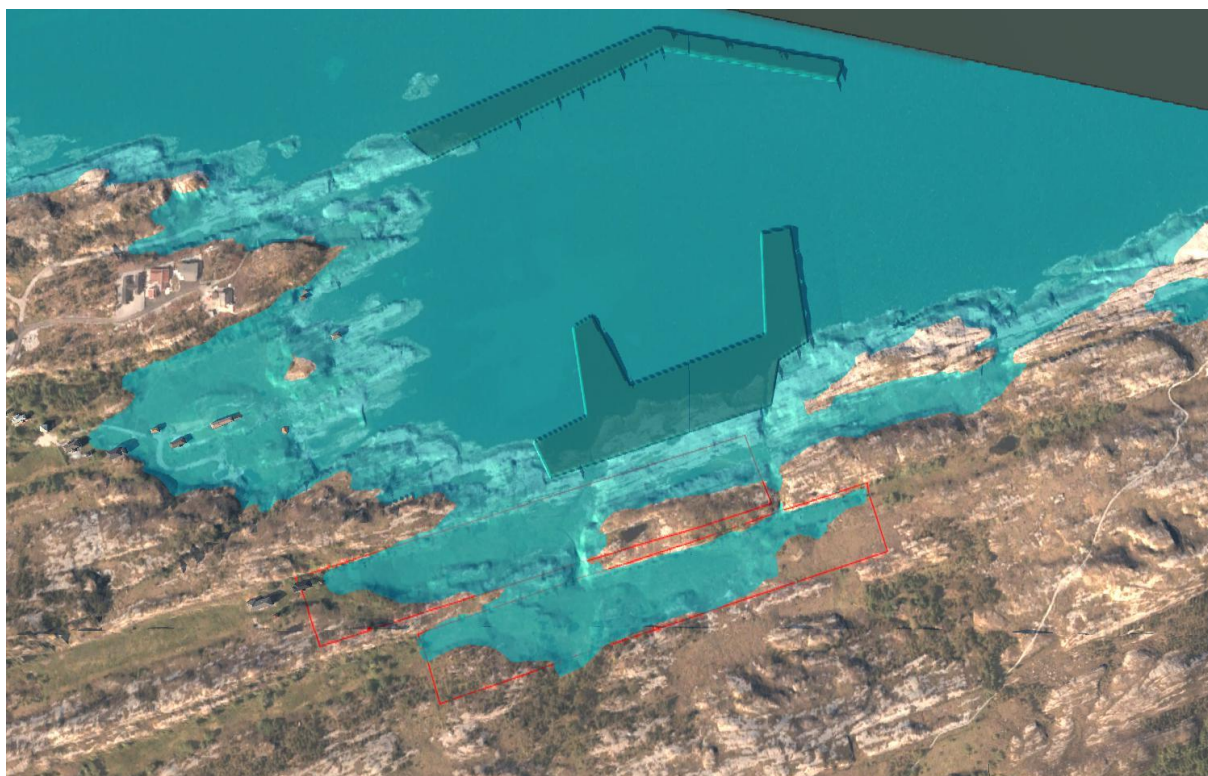
Illustrasjon fra tidlig skisse viser terreng lavere enn kote 7 moh. markert med farge. Mulig plassering av basseng etter alternativ 1 og 2 er markert med rød strek. Kai løsning A er markert i sjø.
