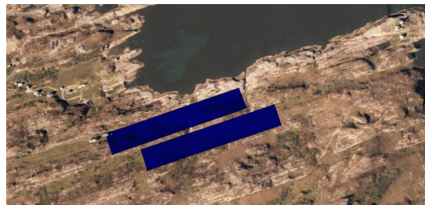
Illustrasjon til venstre viser høyder 0-9 meter med 3 meters intervall. Til høyre prinsipp for plassering av basseng på laveste områder etter alternativ 1 (Nord) og 2 (Sør).
