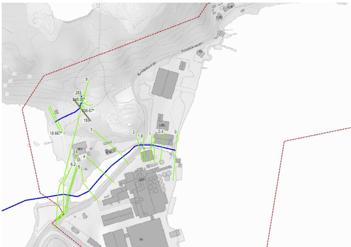
Figur 5-2: Hydraulisk 1D modell for Strømselva og bekken med reguleringsgrensen for planområdet tegnet med stiplet rød linje.
