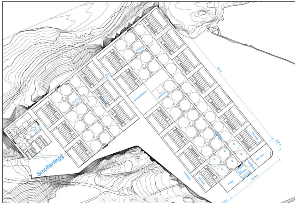
Figur 12: Mulig utforming av oppdrettsanlegget. (AIP/NORCAD)
