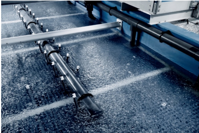
FIGUR 15 - "FIXED BED" BIOFILTRE. KILDE: AKVAGROUP
