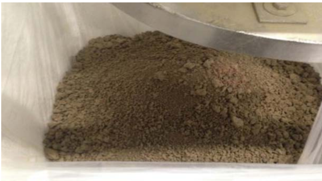
FIGUR 31 - TØRKET SLAM FRA SLAMTØRKEANLEGG. BILDE: YNGVE PAULSEN
