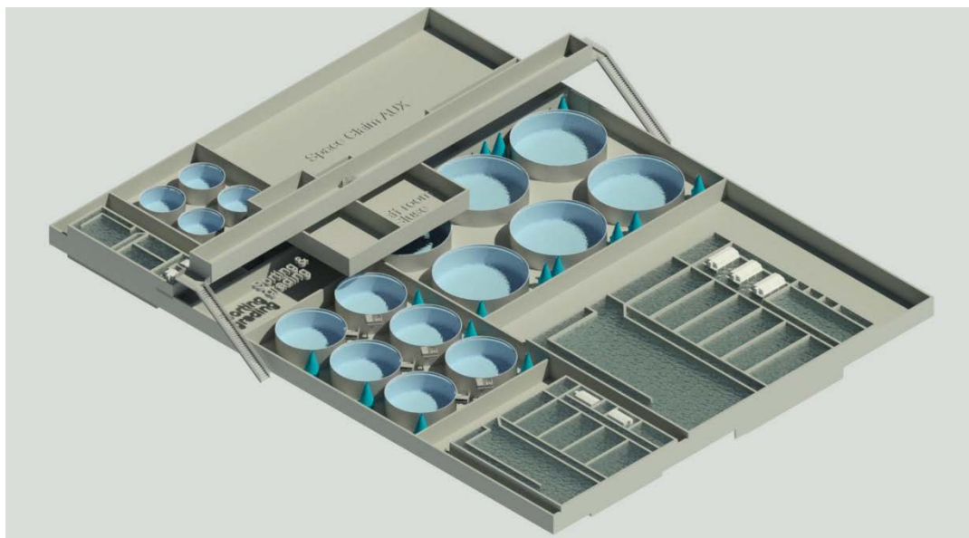
FIGUR 7 - MODUL TIL SMOLTANLEGG MED KAR , RENSEANLEGG, SORTERING OG SLUSER KILDE: AKVAGROUP
